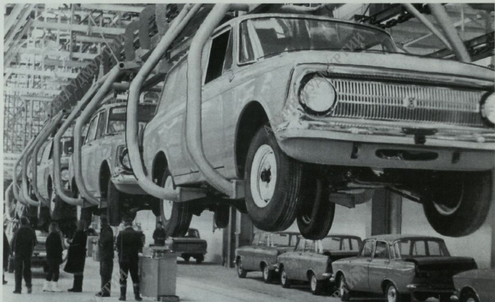
Главный сборочный конвейер Ижевского автозавода. 1978 г.
